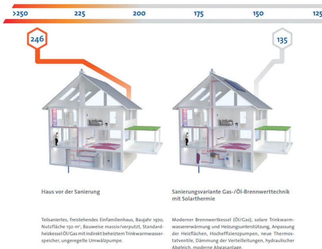
Abbildung 20: Einsparpotenziale durch Nutzung effizienter Heiztechnik (Quelle: BDH 2021)
